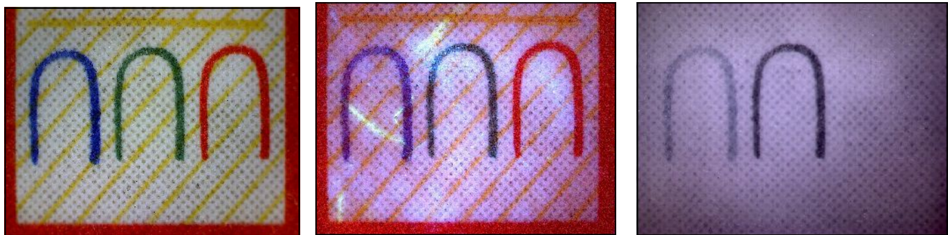
L'esempio si riferisce ad alcuni grafismi prestampati su un assegno bancario, rispettivamente in: luce bianca, UV e nel NIR
