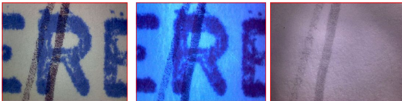
L'esempio si riferisce alla risposta dei pigmenti degli inchiostri tra un timbro con inchiostro Blu e un tracciato a Biro nera, rispettivamente nello spettro del: Visibile, UV e NIR (vicino infrarosso)
