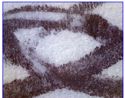
Il solo microscopio (senza distanziali) in modalità 140x , riprende un campo oggetto (sul lato più lungo del sensore) di circa 2,4 millimetri .
