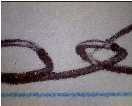
Il solo microscopio (senza distanziali) in modalità 40x , riprende un campo oggetto (sul lato più lungo del sensore) di circa 7,8 millimetri .
