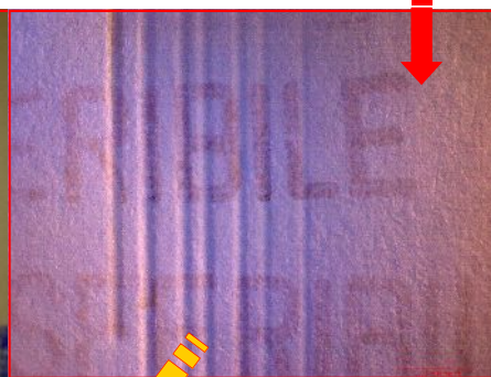
Acquisizione a luce UV (dal microscopio) + IR a fascio radente dalla torcia esterna
