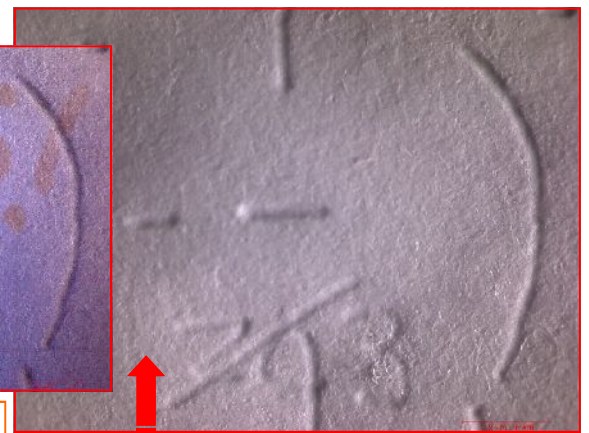
Acquisizione con sola sorgente IR a fascio radente dalla torcia esterna
