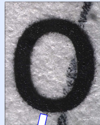
Misura della sensibile riduzione dello spessore di grafismi manoscritti, a seguito di un successivo passaggio del foglio di carta attraverso il trascinamento meccanico dei rulli di una stampante (o di una fotocopiatrice)
